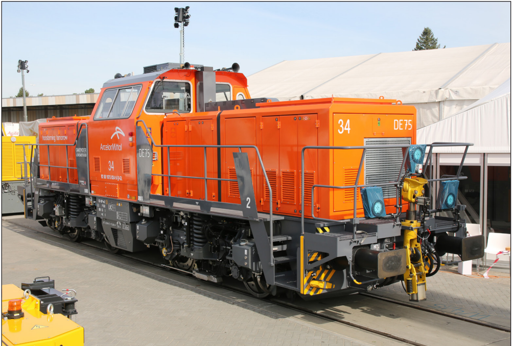
Bei einem Dienstgewicht von 80 t (+/- 3 %) und einer Leistung von 2x 354 kW bringt die Lok 34 der ArcelorMittal Eisenhüttenstadt Transport GmbH eine Anfahrzugkraft von 260 kN auf die Schiene. Bernd Zöllner stand hinter der Kamera.
