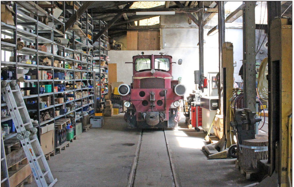
Ein kuriose Maschinchen ist die Lok 22-03 „Stoppelhopper“. Für den Einsatz mit auf Rollböcken aufgeschemelten Regelspurwagen ist sie zusätzlich mit einer Zug- und Stoßeinrichtung für diese ausgerüstet. Foto: Bernhard Mrugalla
