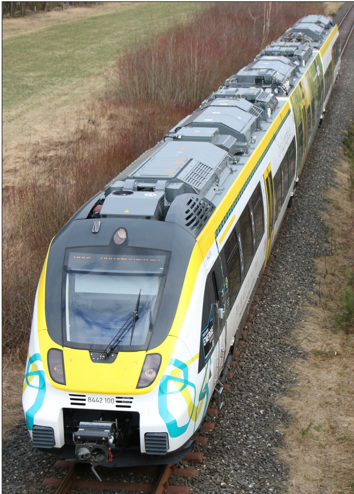
Auf dieser Aufnahme von Bernd Zöllner kann man das vollgepackte Dach erkennen. Dort sind auch die Akkumulatoren untergebracht.
