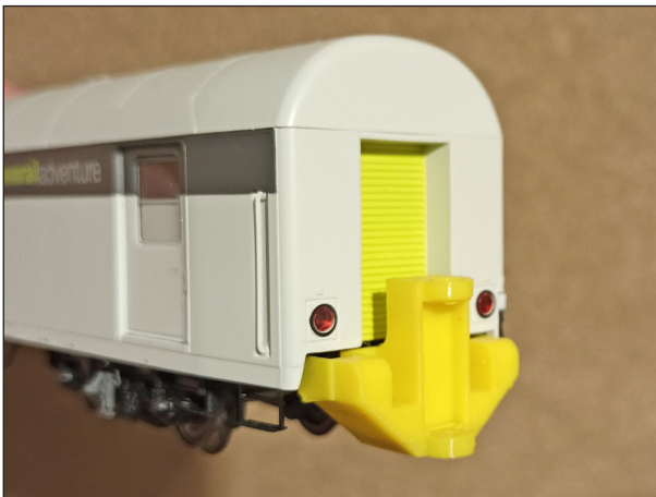
Der gedruckte Adapter ist am Wagen montiert. Die Kupplungsköpfe können nun nach Bedarf montiert werden. Foto: Michael Mrugalla
