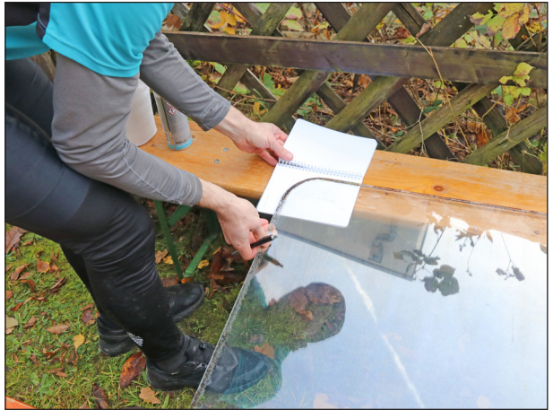
Klaus Probst dokumentierte, wie der Radius der Fensterscheibe abgezeichnet wurde, um ihn im Anschluss vermessen zu können.
