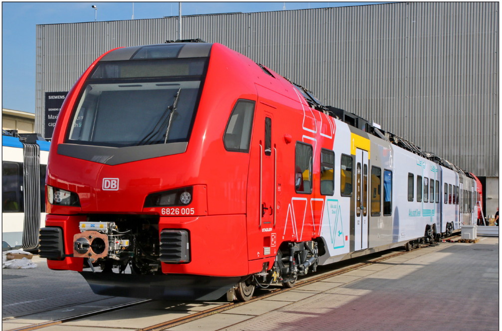
Der Flirt Akku 3 XXL ist, wie der Name schon sagt, ein Akku-Triebzug. Das Stadler-Fahrzeug hat im Akku-Betrieb eine Reichweite von ca. 150 km und kann per Stromabnehmer am Fahrdrabt geladen werden. Fotos (4): Bernd Zöllner
